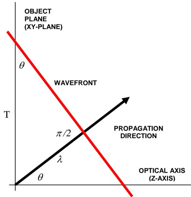
**FIGURE 3. PLANE WAVE PROPAGATION GEOMETRY**
